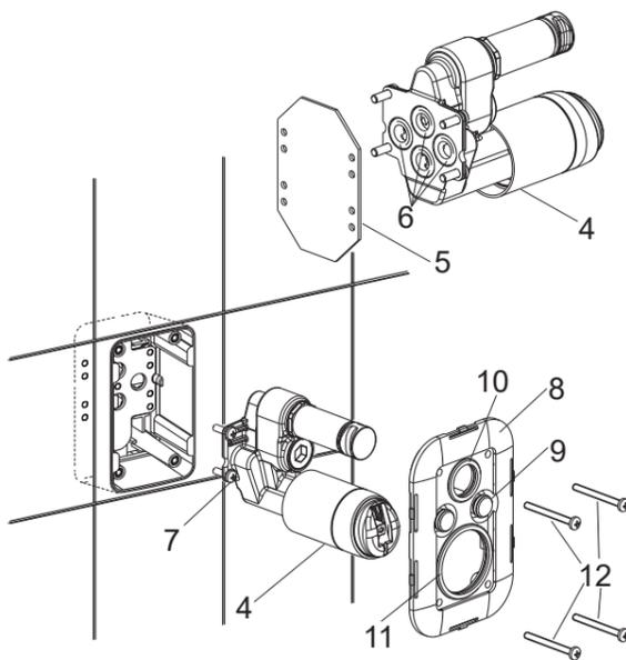
取下阀体组件(4)底部的保护板(5)，**注意：**不要弄丢底部O型圈(6)。
