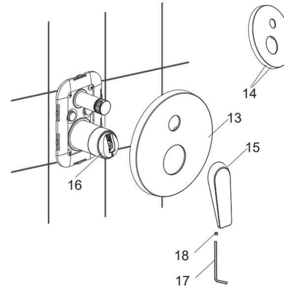
将面板(13)套在安装盘组件上，使开槽(14)向下。将其后推直至与墙面接触。
