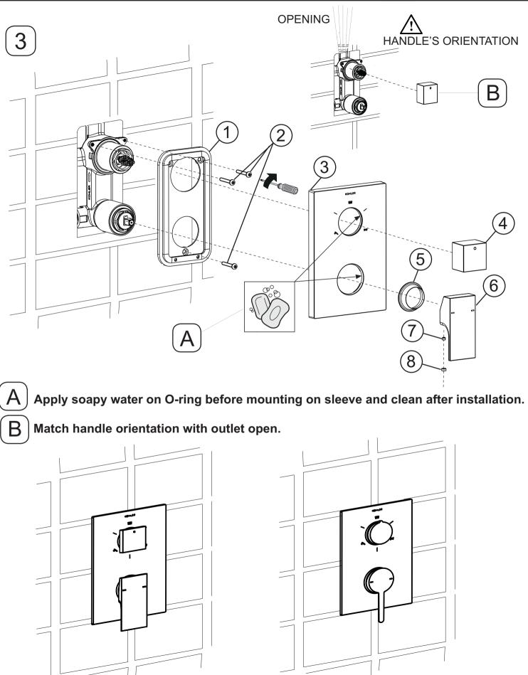
\* INSTALLATION SHOWN IS COMMON FOR ALL THE TRIMS COME WITH 99924IN-\*\* VALVE ASSEMBLY
