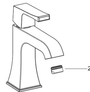
检查并确保所有的衔接螺母都已拧紧, 确保把手在关的位置。打开排水器和主要供水源, 检查并修理有漏水的接口。
