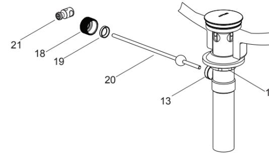
将接头(21)及固定螺母(18)取下, 把塑料垫圈(19)及固定螺母装在球杆(20)上, 把球杆组件插入排水杆的洞口中并穿过止水塞, 拧紧固定螺母。
