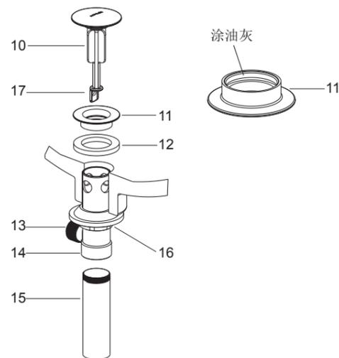
将止水塞(10)、法兰盘(11)、垫片(12)及尾管(15)从排水本体(14)上取下。在尾管螺纹处须缠绕足以密封的密封胶带或涂合适的密封胶装回到排水本体上。把排水本体组件从脸盆下方插到脸盆中, 排水杆口(13)朝后方。把法兰盘带垫片旋入到排水本体中, 从下方用手拧紧锁紧螺母(16)。
