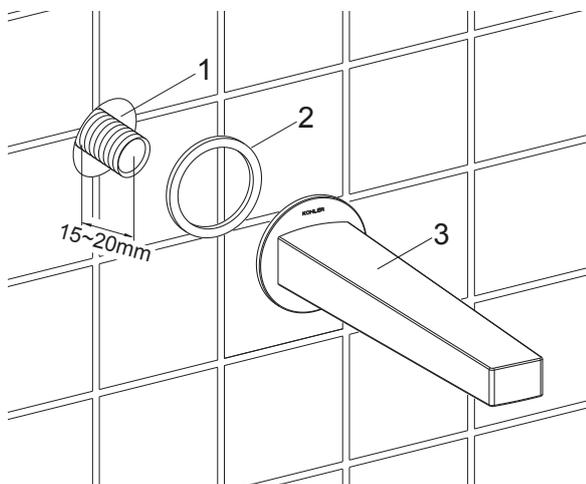
在G1/2"接管(1, 客户自备)两端螺纹上缠绕足以密封的密封胶带或涂合适的密封膏。安装G1/2"接管, 接管露出墙外15~20mm。
