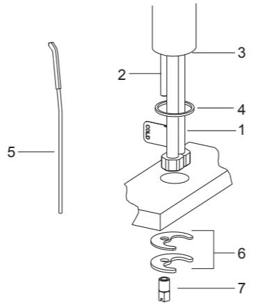
将水龙头组件插入脸盆的安装孔中，调整水龙头，从脸盆的下方把托架(6，橡胶垫片放在上面)套入固定螺栓，并旋上螺母(7)以固定水龙头。
