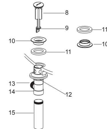
**注意：**如果需要，可直接在法兰盘(10)底面沿周围涂一圈密封油灰，或其他密封剂，而不使用垫片(11)。
