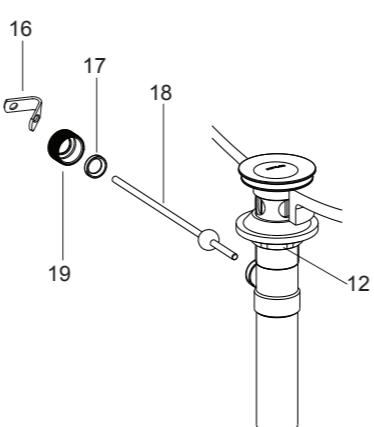
确保球杆(18)指向脸盆后方，用扳手拧紧排水本体上的锁紧螺母(12)。
