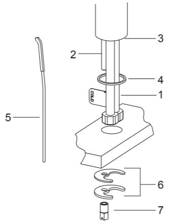
将水龙头组件插入脸盆的安装孔中，调整水龙头，从脸盆的下方把托架(6，橡胶垫片放在上面)套入固定螺栓，并旋上螺母(7)以固定水龙头。
