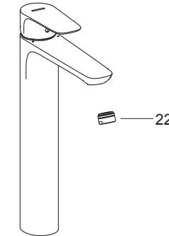
拆下起泡器组件(22)。打开水龙头冷热水，让水流约一分钟以清除杂质，检查渗漏。冲洗起泡器组件，关闭水龙头，重新装回起泡器组件。
