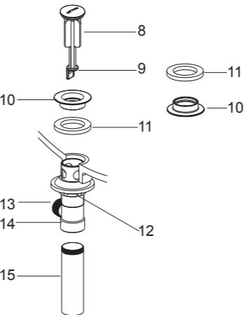
**注意：**如果需要，可直接在法兰盘(10)底面沿周围涂一圈密封油灰，或其他密封剂，而不使用垫片(11)。
