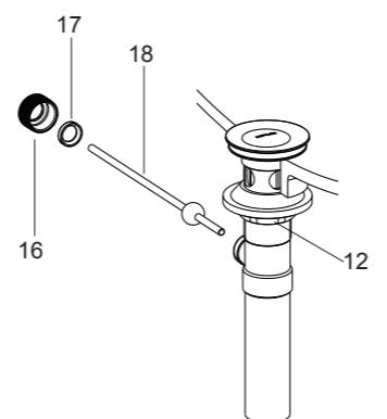
确保球杆(18)指向脸盆后方，用扳手拧紧排水本体上的锁紧螺母(12)。
