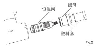
将螺母和塑料套卸下。小心地卸下温控阀。用热醋进行清洗。
