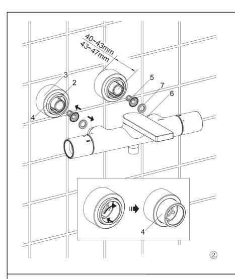
情形一: 当接头(2)凸出墙面的 距离是40~43mm时,将滤网(5) 装到接头内。将垫片(7)装到螺 母(6)内。
