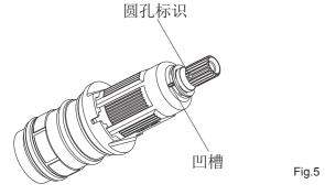
**注意**:确保拆卸、安装过程中不要转动温控阀轴。如不小心转动了阀轴,要调整阀轴使外齿上的圆孔标识与相邻的塑料套上的凹槽对齐,或者按前述方法进行调整。
