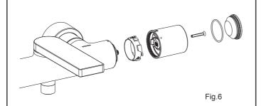
安装阀轴及温控把手(不要转动温控阀轴),使参考标识同数字38对齐,拧紧螺钉。安装把手上盖。
