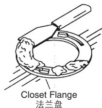
用涂油灰刀拆除地上的旧密封垫圈及座便器法兰盘，拆除及扔掉旧的T型螺栓。
