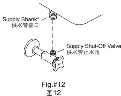
我们建议使用软管(不随货供应)来连接供水管与座便器进水阀。如果您使用硬管(不随货供应)连接的话，连接时要注意不要在进水阀的底部施加横向压力，并注意硬管必须与供阀口完全吻合，以免强行连接日后会损坏接口。
