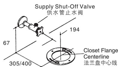
安装厕所供水管止水阀，使之离地线67mm，也离法兰盘中心线左面194mm。
