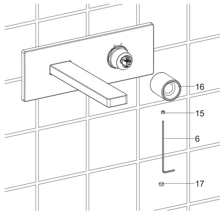
关闭阀芯，用2mm六角扳手(6)旋松把手的螺钉(15)。
